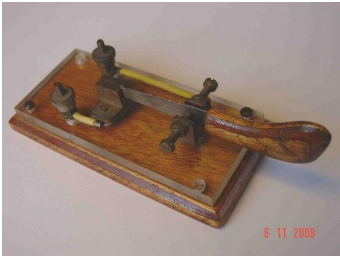
Pastička jednopáčková, robustná, z noža s drevenou rukoväťou
