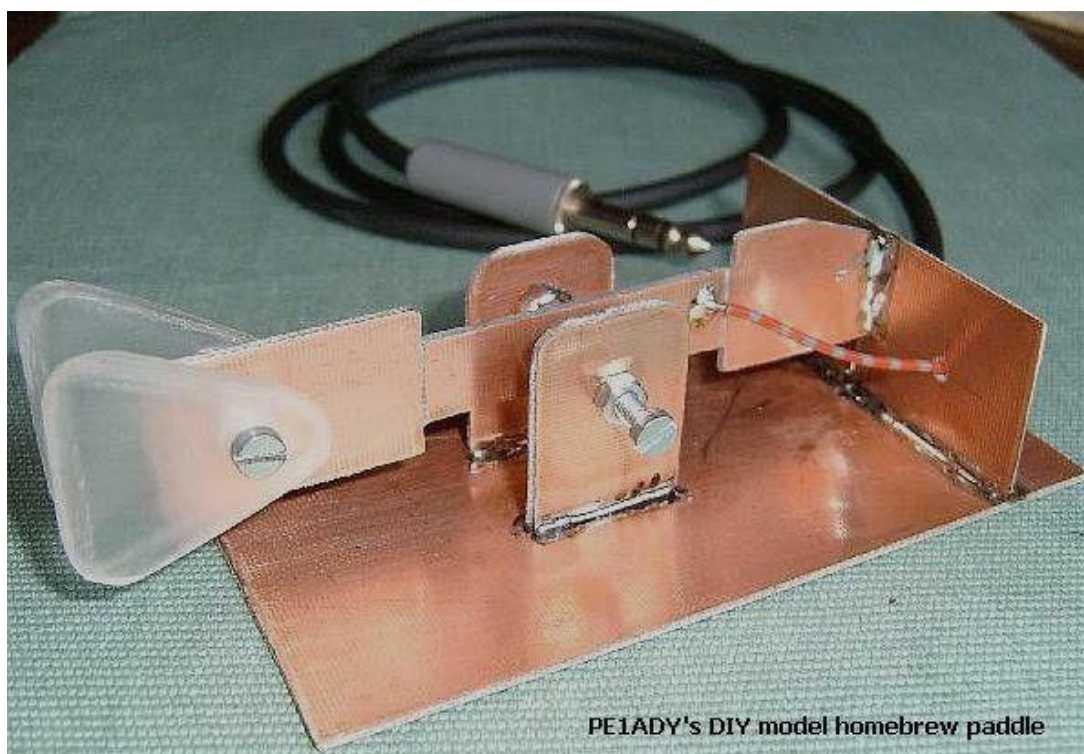
Pastička jednopáčková z plošného spoja podľa PE1ADY
