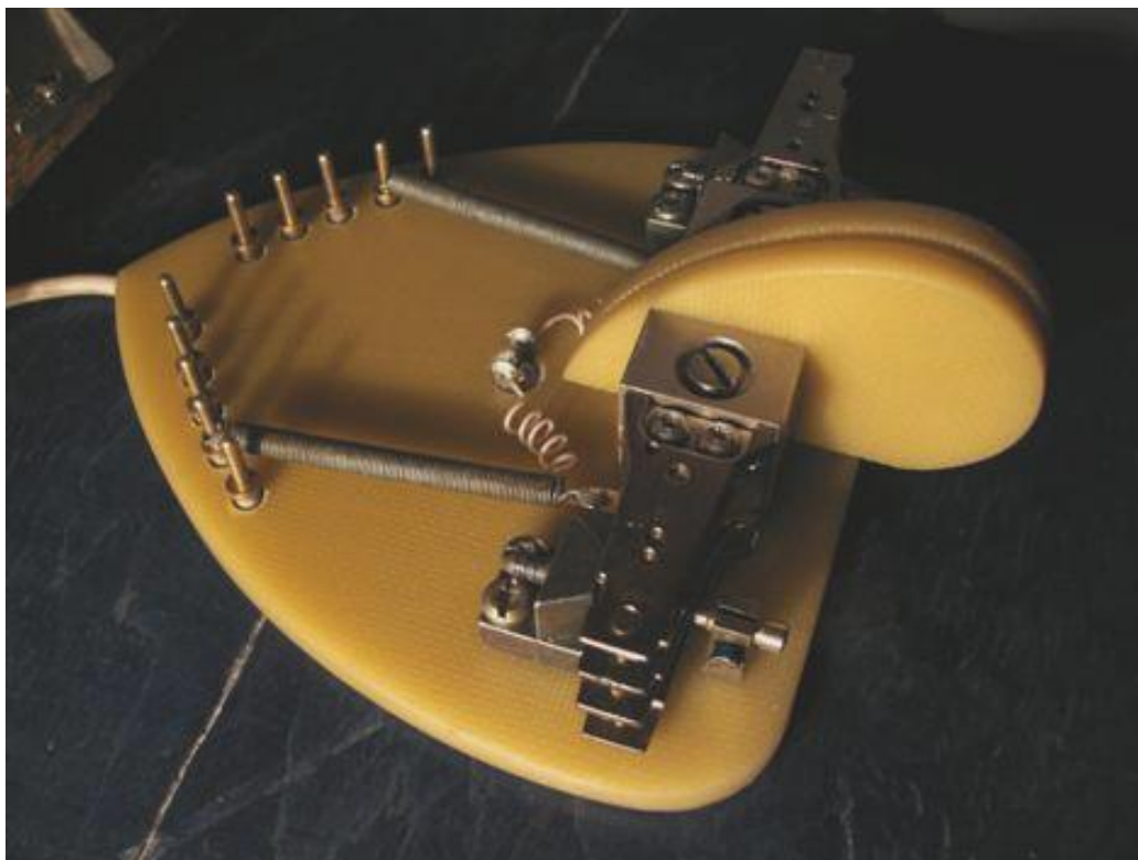
Pastička jambická UC1CC, súčiastky z HDD
