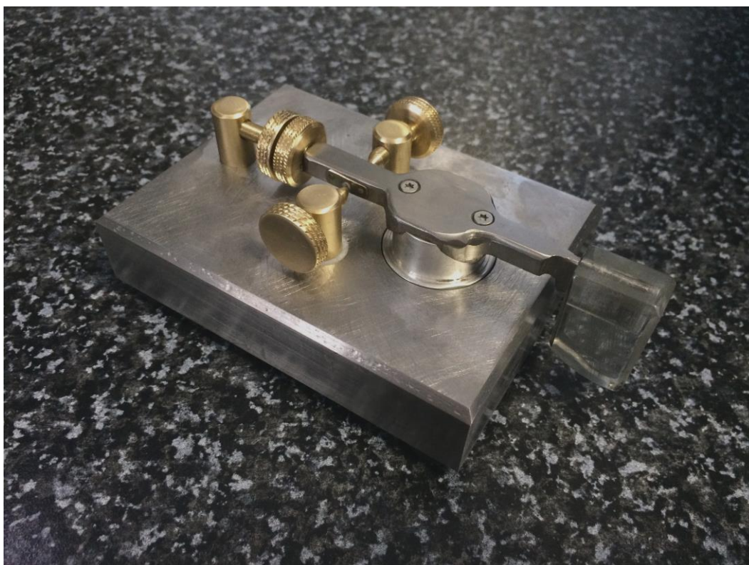
Pastička jednopáčková magnetická RA6G, súčiastky z HDD
