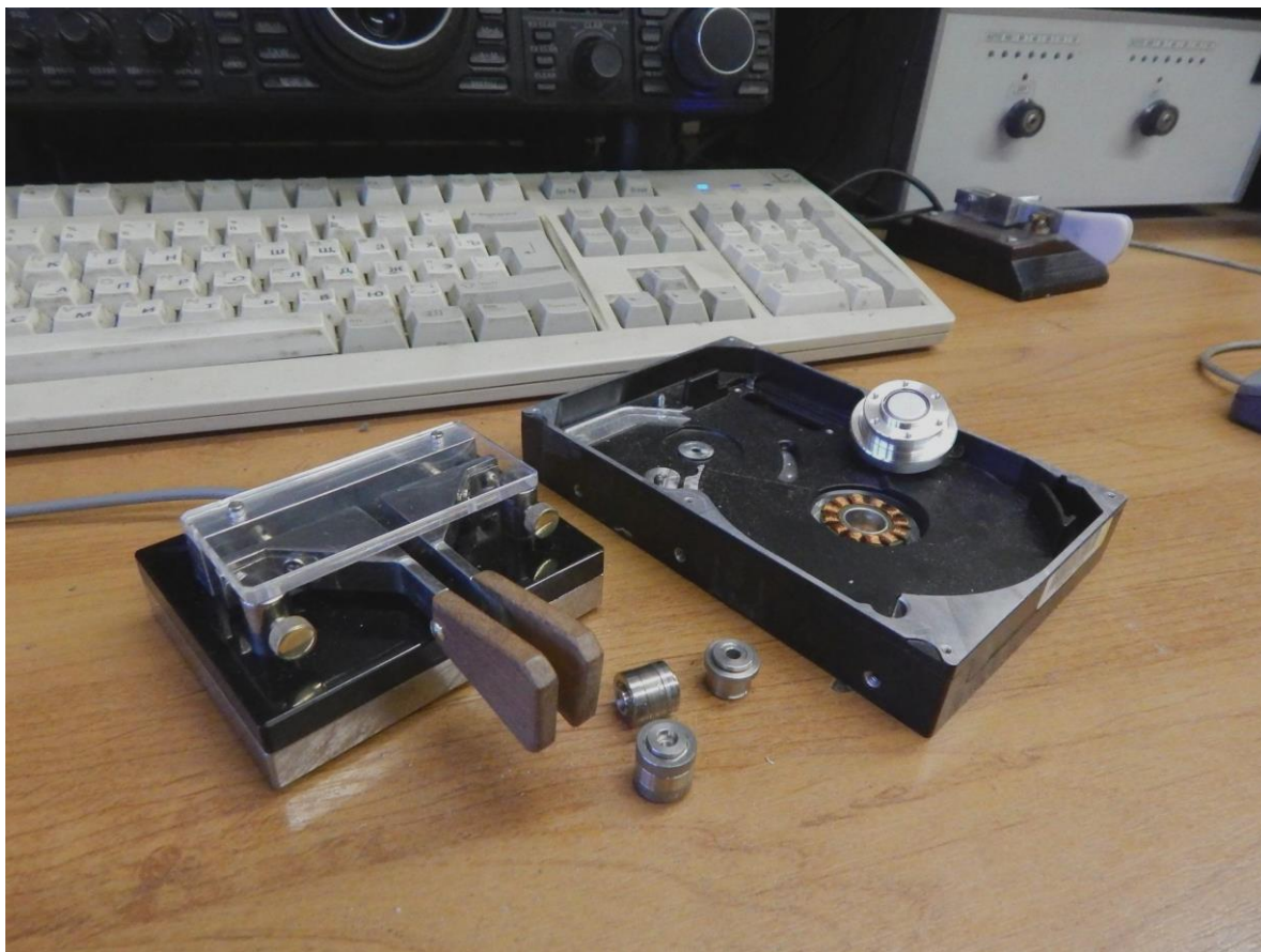
Pastička jambická magnetická RV3AE, súčiastky z HDD
