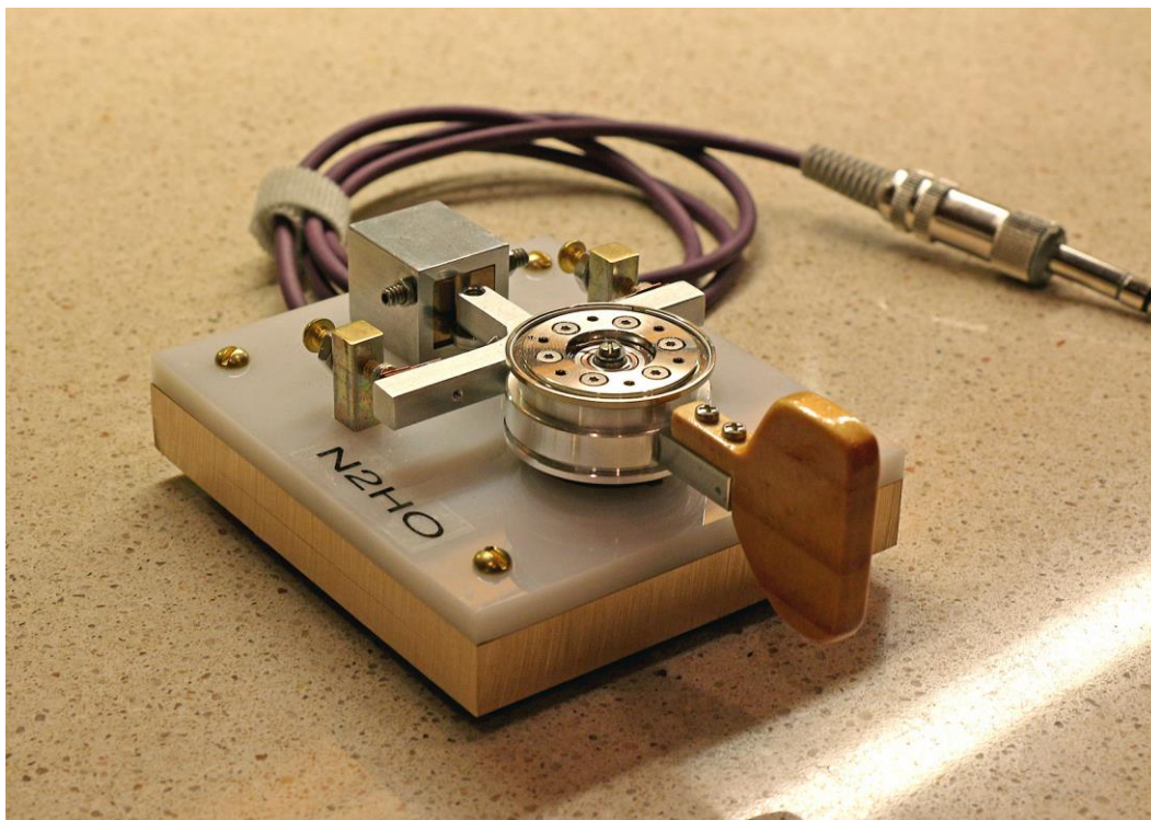
Pastička jednopáčková magnetická N2HO, súčiastky z HDD http://n2ho.blogspot.sk/p/blog-page_308.html
