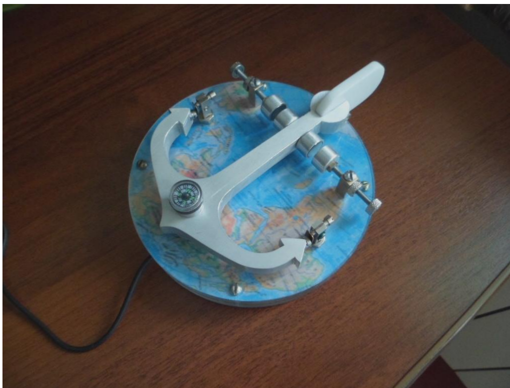
Pastička jednopáčková magnetická RL6MF, kotva
