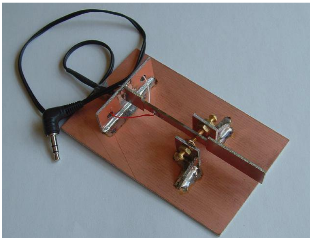
Pastička jednopáčková z plošného spoja
