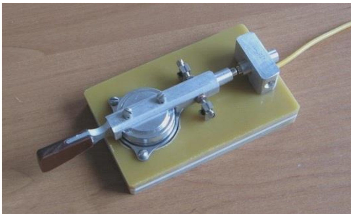
Pastička jednopáčková magnetická UT2IV, súčiastky z HDD
