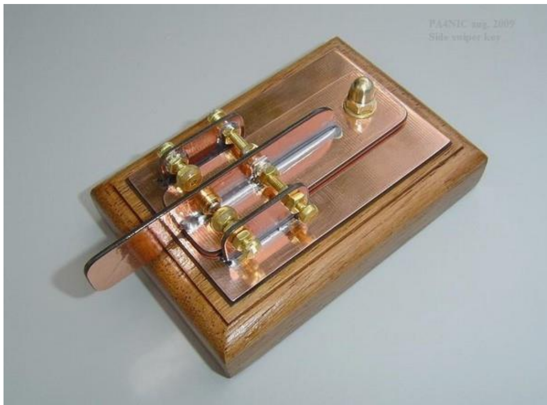
Pastička jednopáčková z plošného spoja s dreveným podstavcom
